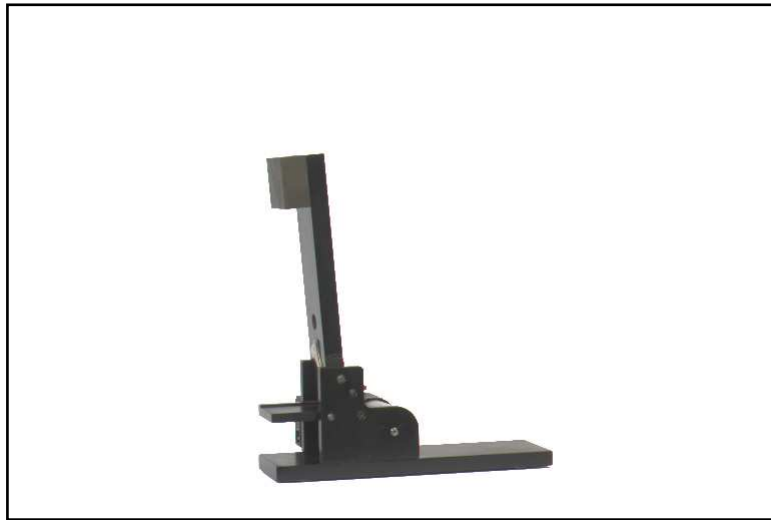
Imagen 1: Posición inicial de la máquina de extensiones antes de colocar el rodillo con tinta.
